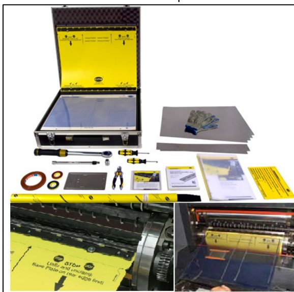
Figura 1 – Sistema RSP 2.0 instalado na unidade impressora de uma máquina offset
