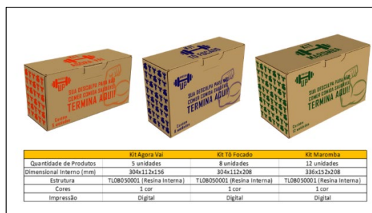
Figura 4. Design e estrutura para caixa de embarque/entrega Protein UP
